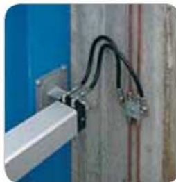
Conexión con el bloque de derivación con racores de 6 vías
